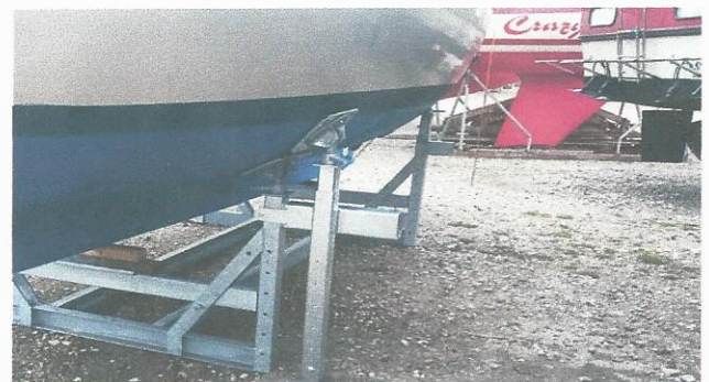
3 to Systembock mit zusätzlichen Zubehörteilen und Kielbalken aus Stahl
